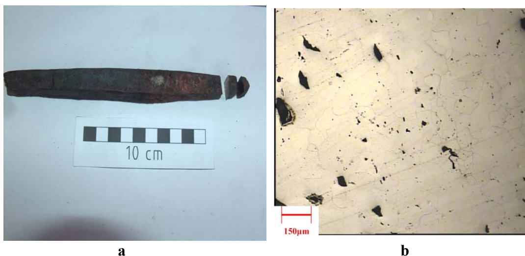
23. ábra Kovácsolt vasrúd – a) minta; b) metallográfiai csiszolat (50x)
