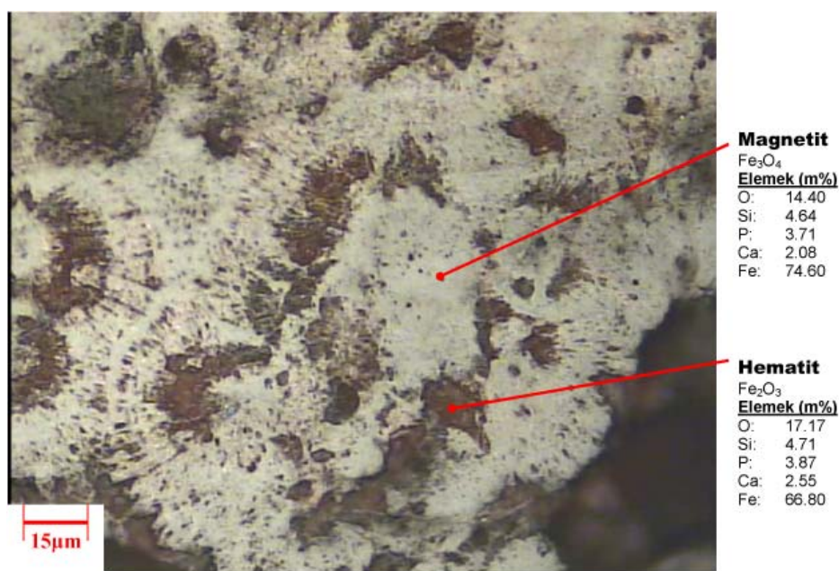
17. ábra: Pörkölt gyepvasércminta metallográfiai csiszolatának fénymikroszkópos képe (500x) és fázisok összetétele az EDAX mérések alapján
