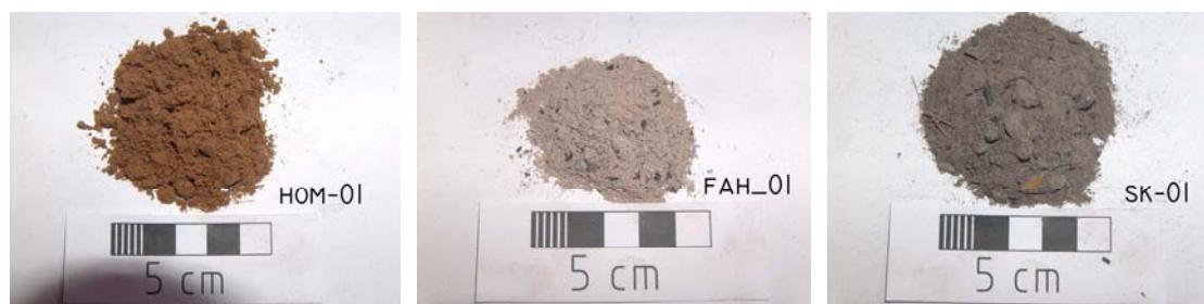
18. ábra: A salakképzésre használt anyagok – a) homokminta; b) fahamuminta (fenyő); c.) salakképző keverék minta
